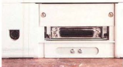
Le interfacce standard parallela Centronics e seriale RS422, il semplice pannello operativo ed una veduta laterale che mostra l'ingombro della stampante.
